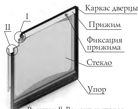
Рисунок 8. Ремонт светорозрачного экрана дверцы модели «Витра»
